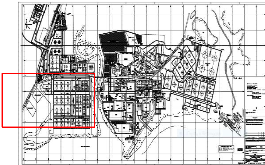
Figura 6: Planta Geral de Locação das Subestações da RLAM (SA-V-01163), cujo arquivo anexado em PDF, permite a exata visibilidade e todas as Subestações da RLAM, inclusive do Parque de Tanques Niterói Norte e Sul, destinado ao armazenamento de produtos acabados (U-46), edificado sobre o aterro em área da União
